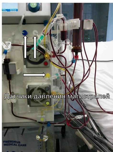
Рис. 3. Система датчиков контроля давления в магистрали экстракорпорального контура (обозначены стрелками на примере multiFiltrate Ci-Ca ® (Fresenius Medical Care Deutschland GmbH)).
